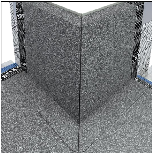
6 Überlappung der Dachbahn durch Eckschnitt vermeiden (ebene Auflage für Multirahmen) Avoid overlapping of the roof sheeting by corner cutting (flat surface for multi frame)
