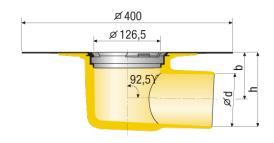
Vor dem danach erfolgenden Einsetzen des Aufstockelements ist der Aufkleber zu entfernen. Bei Wärmedämmstärken über 160 mm können Aufstockelemente miteinander (ineinanderstecken) kombiniert werden. Dabei ist das Absägen, wie beschrieben, sinngemäß durchzuführen.
