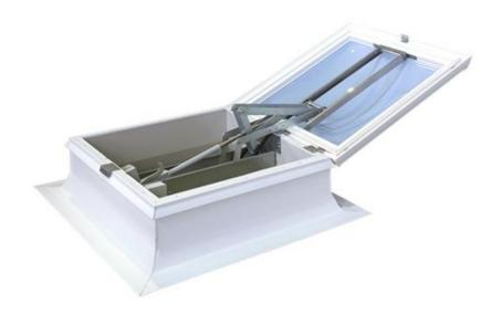
Rauch- und Wärmeabzüge fumilux® 4000-EAZ sind Komplett-Produkte, bestehend aus einer Lichtkuppel und der werksseitig in den Aufsetzkranz vormontierten Rauchabzugsmechanik. Die Anbindung der Lichtkuppel an den Aufsetzkranz erfolgt schnell und einfach durch werksseitig vormontierte Scharniere. Zusätzlich: Lieferung mit Windleitblech zur sicheren Rauchableitung, auch bei Seitenwind.
