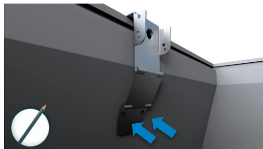
5 Bohrlöcher anzeichnen Mark holes
