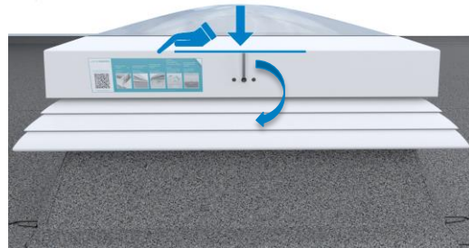
14 Lichtkuppel durch 90° Drehung des Vierkants verriegeln Lock the skylight by turning the square shaft 90° clockwise
