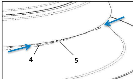
Bild 4: Scharnierbolzen einschlagen
