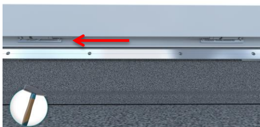
13.2 Scharnierbolzen einschlagen Drive in hinge bolts
