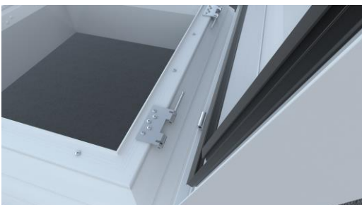
13.1 Geschlossene Scharniere ausrichten Align bolted hinges
