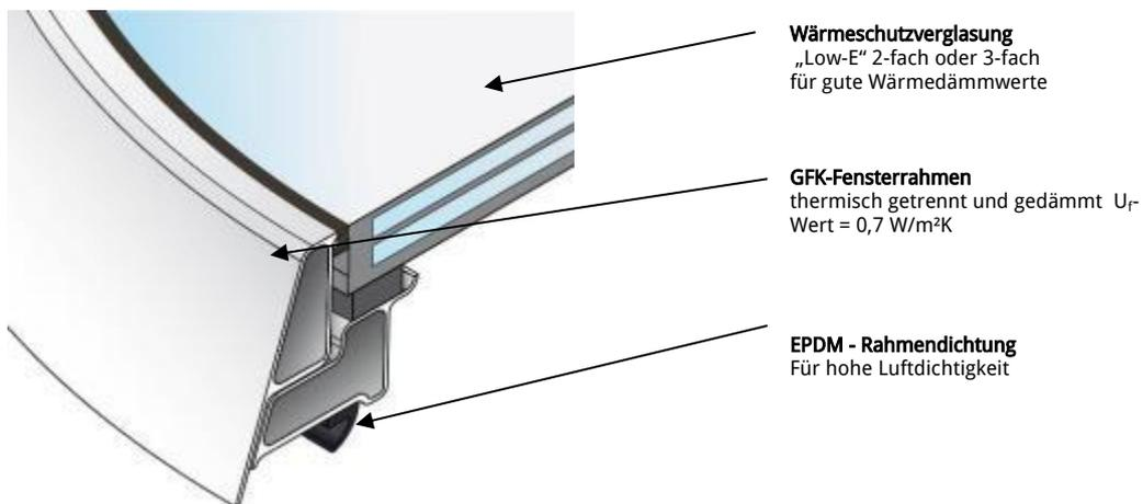
Das Flachdachfenster ist besonders geeignet für den Einsatz in Büro und Wohngebäuden. Durch die dampfdichte Verglasung ist auch ein Einsatz in Bädern oder Räumen mit hoher Luftfeuchtigkeit problemlos möglich.
