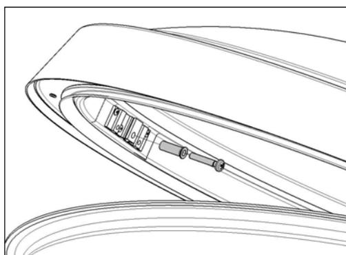
Bild 9: Montage Verriegelungsbolzen
