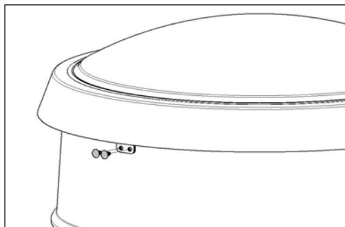
Bild 8: Montage Lichtkuppelnägel
