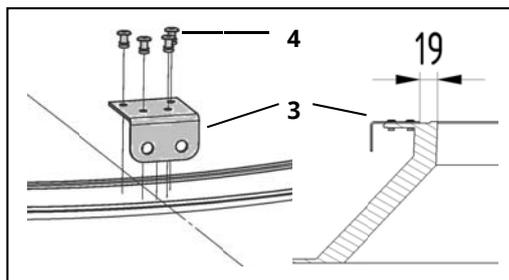
Bild 2: Mae fur Befestigungswinkel
